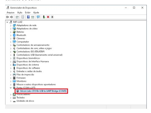
Caso apareça desse jeito, desconecte e conecte o cabo USB no computador. Persistindo o problema reinstale o driver CP210x\_VCP\_Win7.
